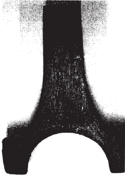
Rys. 1. Prawidłowy przebieg włókien w przekroju korbowału. Trawiono odczynnikiem Jacewicza.
